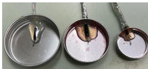
圖 22 用 K-type 熱耦溫度計測量燃燒中的甲醇溫度。大中小三種火力是分別用鋁盒 C、B、A 的蓋子裝甲醇燃燒。
