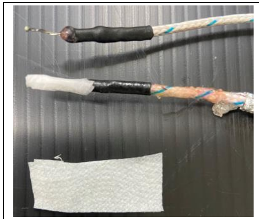
圖 29 用 1*3cm*cm 的衛生紙捲熱耦溫度計探頭，滴 3 滴甲醇讓它蒸發降溫。
