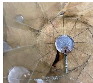
圖 23 將有 K-type 溫度計的鋁盒放進裝置後裝入八分滿甲醇燃燒。
