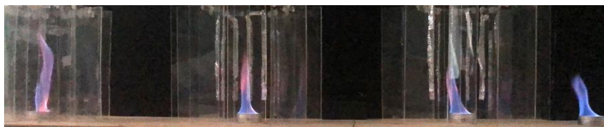
圖 15 四個火焰由左到右分別是導流板偏斜 90 度、70 度、50 度和對照組。
