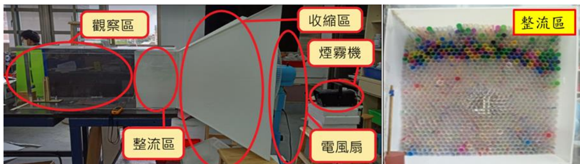
圖 9：風洞模型構造介紹
