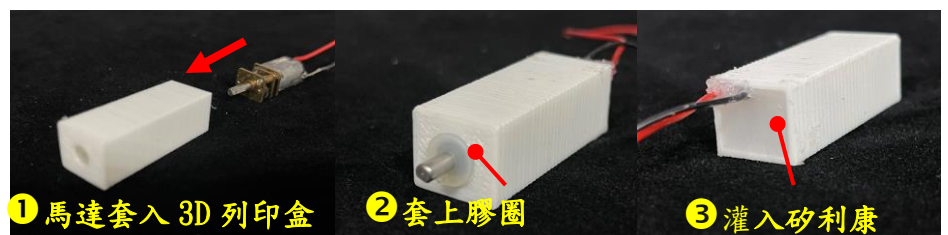
▲圖 2-2：將馬達套入 3D 列印的防水盒，套上膠圈，灌入矽利康，達到完全地防水。
