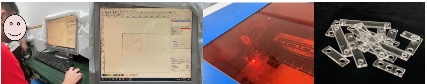
▲圖 2-3：用「台灣三軸雷射切割雕刻軟體」繪製所需部件圖，驅動雷射切割機切割出所需的連動桿。
