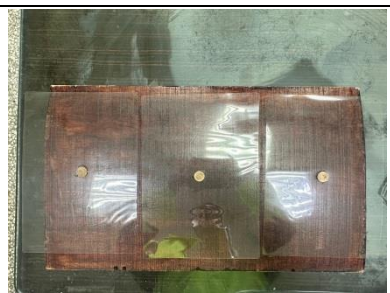
圖 7、將護貝膜挖除約 1 元硬幣大小範圍
