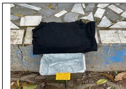
圖 54、透貼置鋁箔紙的箱體注入三分之一箱體的水並搭配有穿過的衣服(1)
