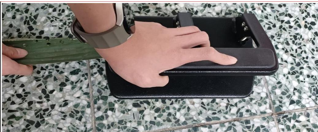
圖 1-1 使用打孔器打出許多葉錠
